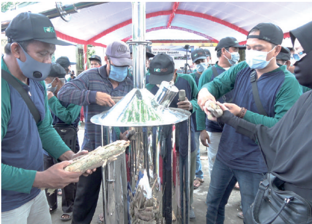
GAMBAR 7.6. Pembuatan asap cair berpendingin stainless steel (Foto: Puslitbang Hasil Hutan)
