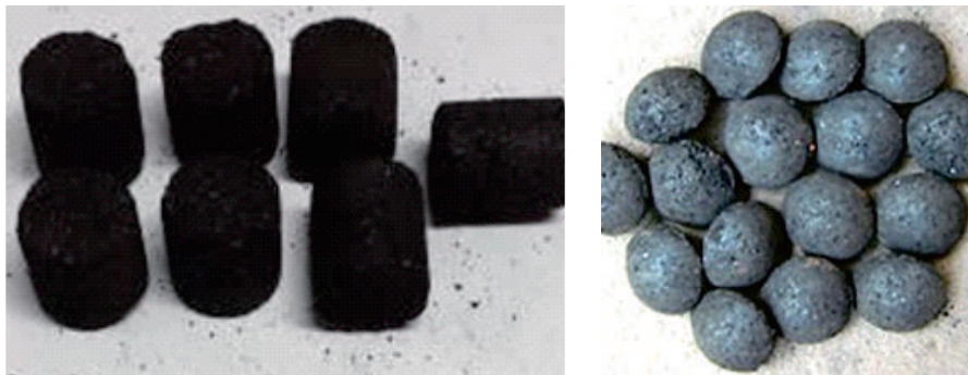
Gambar 10.4. Bentuk briket arang: silinder, kotak dan jengkol (Foto: Darmawan, Hendra)
