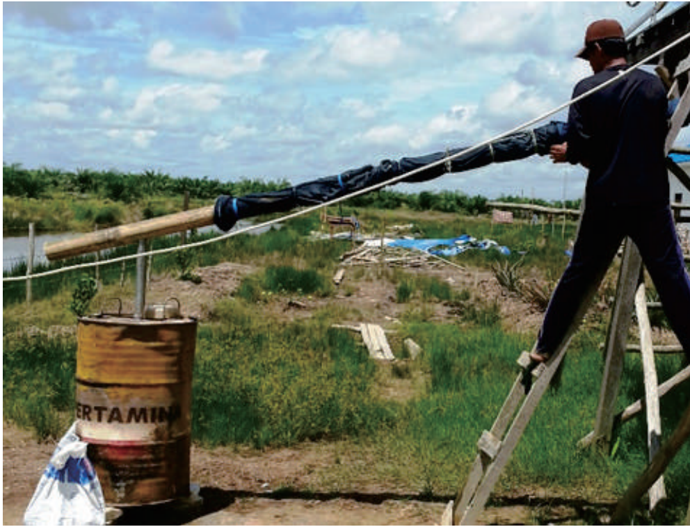
GAMBAR 7.5. Produksi asap cair berpendingin bambu (Foto: Darmawan)
