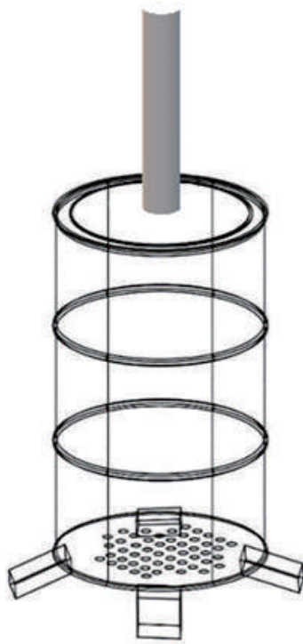
GAMBAR 8.3. Sketsa dan pembuatan arang menggunakan drum (Ilustrasi: Darmawan; Foto: Hendra)
