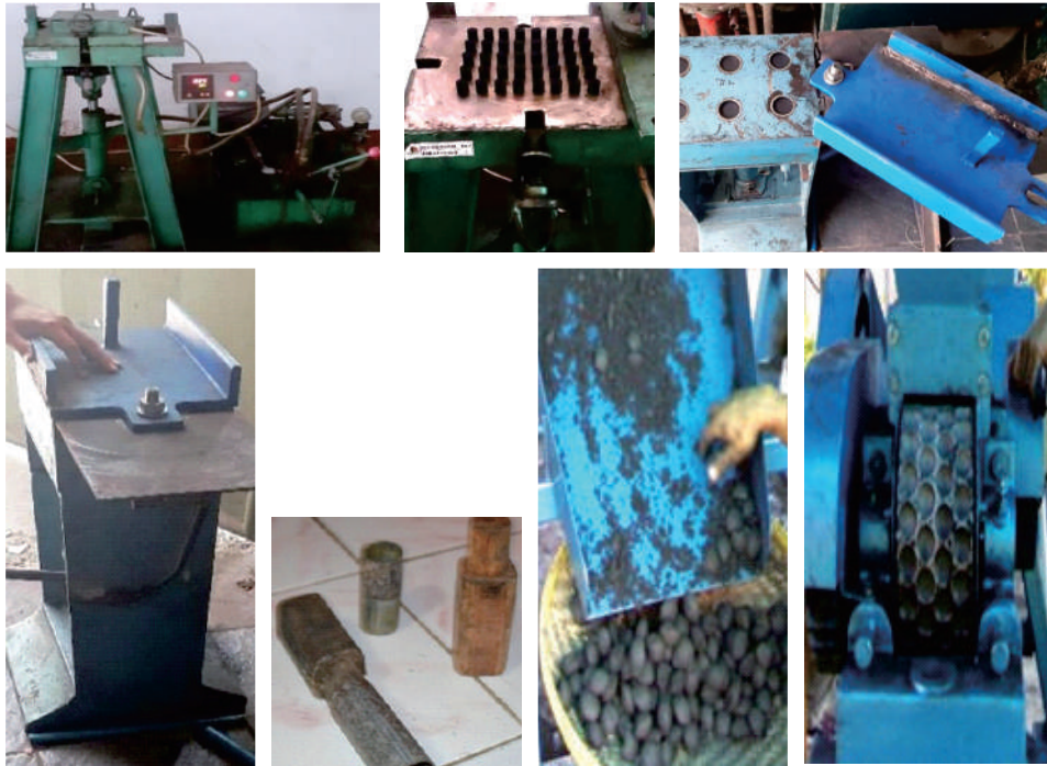
Gambar 10.3. Beberapa alat cetak dan bentuk cetakan briket: cetak hidrolis listrik, cetak hidrolis manual, cetak pres mekanis mesin dan cetak manual (Foto: Darmawan, Hendra, Endang)
