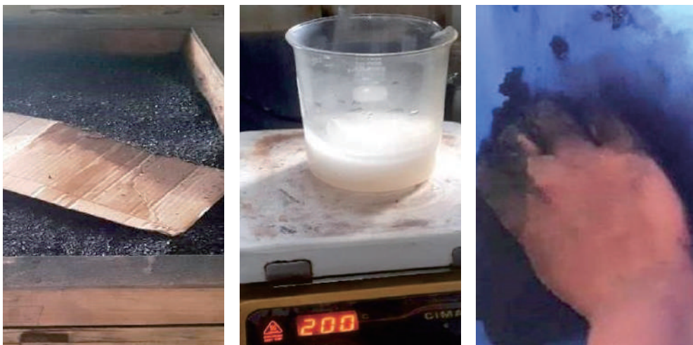
Gambar 10.2. Persiapan pembuatan briket: pengayakan arang, pembuatan perekat, pengadukan arang dan perekat (Foto: Darmawan)
